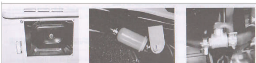
Figura 9 –La sostituzione del filtro d'aria
