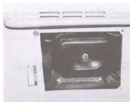
Figura 9 – Schimbarea filtrului de aer
